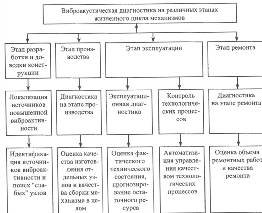
Рис. 6.1. Области применения ВАД на этапах жизненного цикла машин и оборудования
