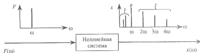
Рис. 6.6. Прохождение гармонического воздействия через нелинейную систему:
