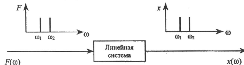
Рис. 6.4. Возбуждение колебаний линейной системы: F(\omega) – спектр входного воздействия; x(\omega) – отклик системы
