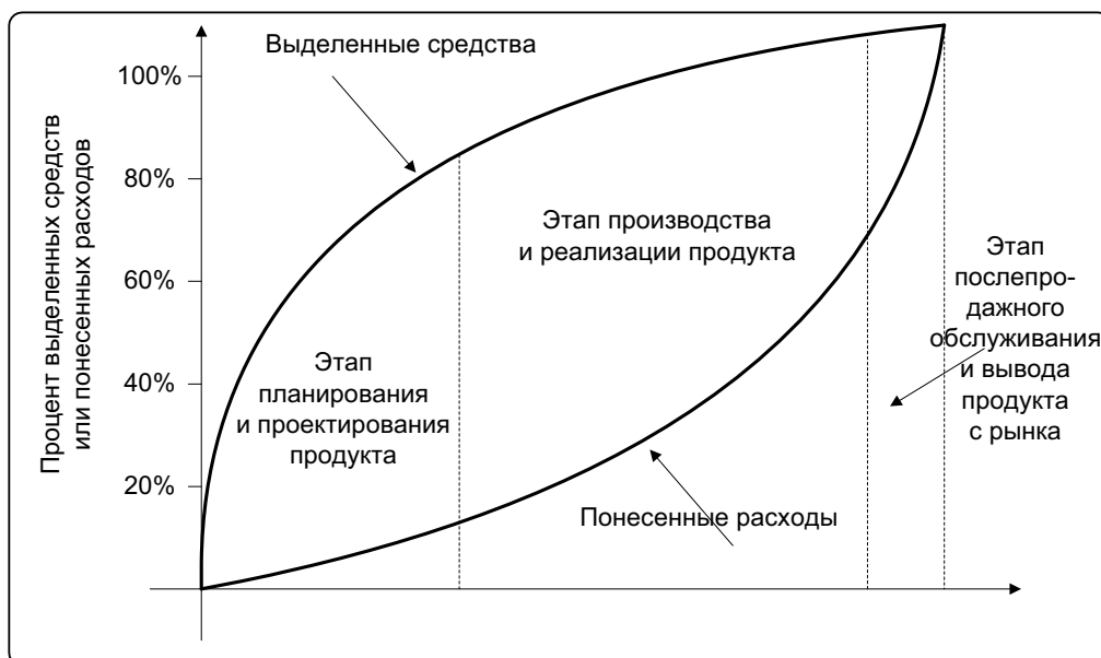
Рис. 15.1. Этапы жизненного цикла продукта: зависимость между выделенными средствами и понесенными расходами
